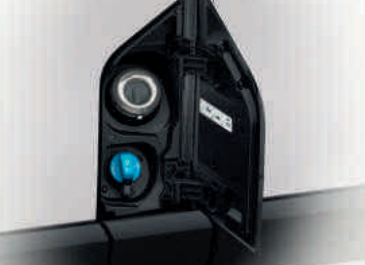
Ford Easy Fuel mit Komfort-Tankverschluss und Fehlbetankungsschutz
