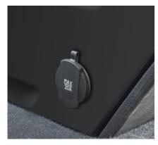
Der **12-Volt-Anschluss** links unten im Bereich des Beifahrersitzes bietet eine zusätzliche Stromversorgung im Fahrzeug.
