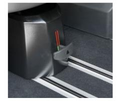
Der **flexible Multifunktionsboden** ermöglicht ein individuelles Positionieren des Tisches und der Einzelsitze.
