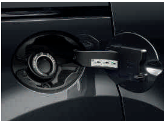
Ford Easy Fuel Komfort-Tankverschluss und Fehlbetankungsschutz (serienmäßig)
